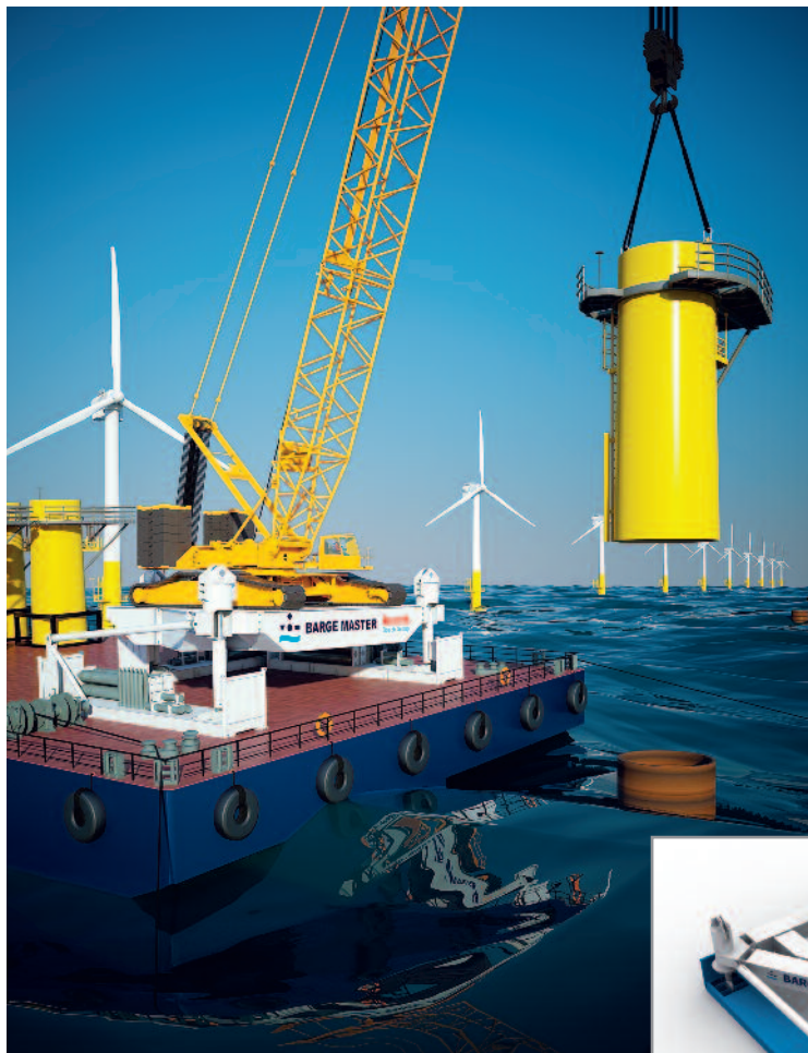
Artist impression van een Barge Master in actie. De inzet toont de drie vrijheidsgraden ( heave, roll en pitch ) waarvoor de deïning wordt gecompenseerd. Illustraties: Barge Master
