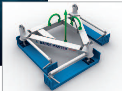
Artist impression van een Barge Master in actie. De inzet toont de drie vrijheidsgraden ( heave, roll en pitch ) waarvoor de deïning wordt gecompenseerd. Illustraties: Barge Master
