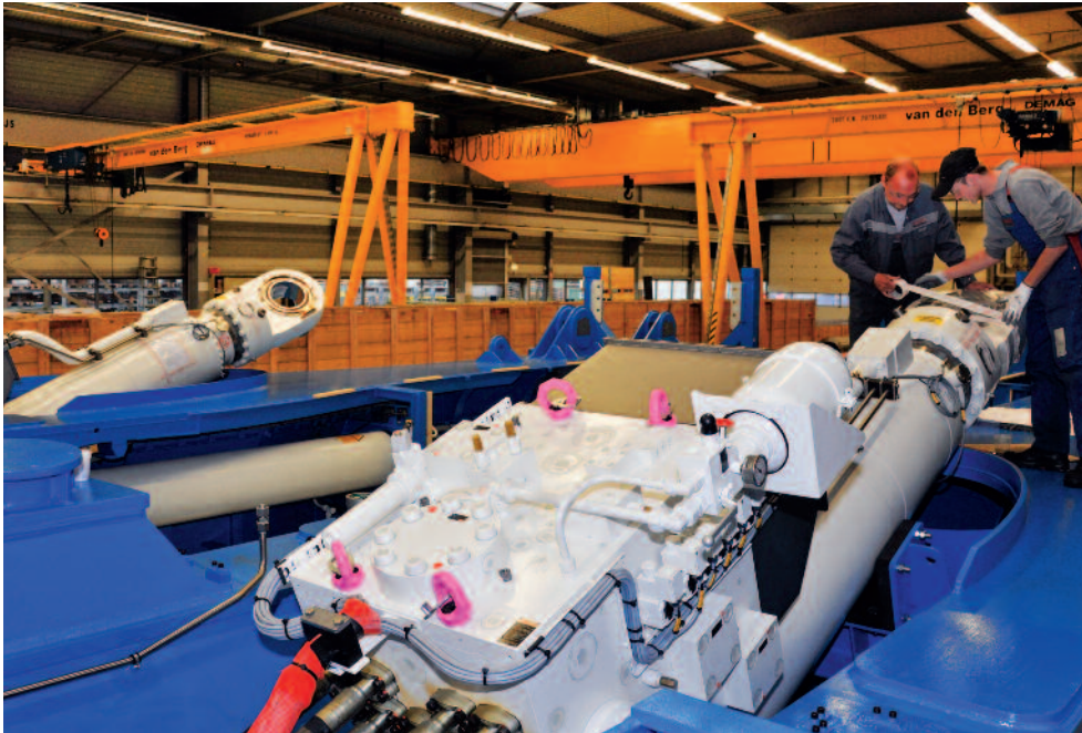
Productie van de cilinders voor de Barge Master bij Bosch Rexroth. Foto: Suzanne van Griensven/Bosch Rexroth
